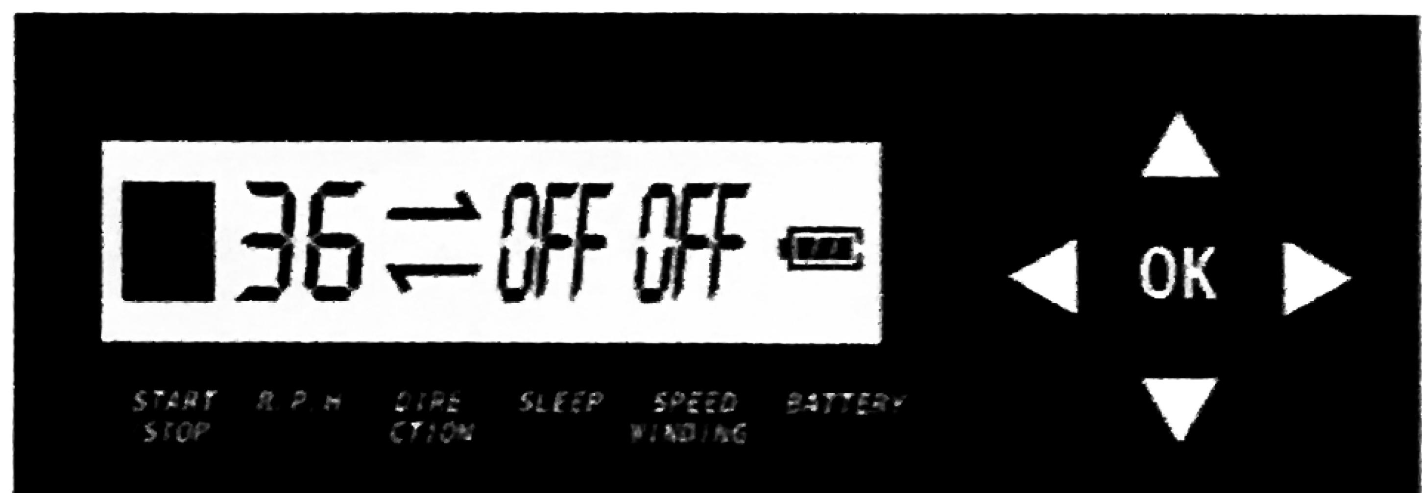
Начальная настройка: 36 оборотов в каждый час, два направления вращения (в частности, 18 оборотов по часовой стрелке, 18 оборотов против часовой стрелки), режим сна - выключен, режим быстрой подзаводки часов - выключен.
